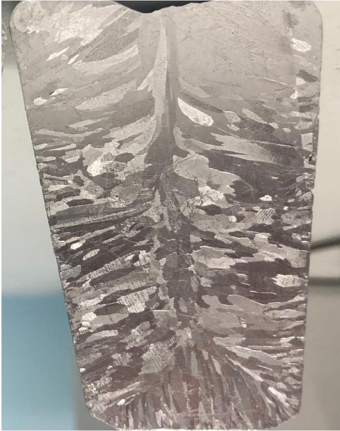
Alliage Al-Si. Solide (lingot) sorti du creuset, coupe longitudinale.
